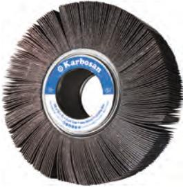
Dayanıklı ve esnek pamuklu bez mesnetten ve Alüminyum Oksit aşındırıcı zımparalardan yapılmıştır. Kaynaklı ve çapaklı yüzeylerde kaba ve ince zımparalama işlemi için uygundur. Yüksek talaş kaldırma kabiliyetine ve optimum ömür özelliğine sahiptir.
