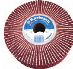
Polisaj öncesi yüzey hazırlama için uygundur. Bir sıra 100 kum zımpara bir sıra Afine kalite elyaf parçadan oluşur. Zımpara ve elyaf kombinasyonu ile hem agresif hem de hassas zımparalama işlemi için uygundur.
